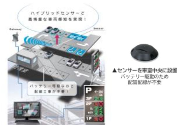
IOTセンサーは配管、配線が不要なため設備コストを大幅に抑えることが可能。満車表示の正確性が高まり、お客様の利便性も向上。
