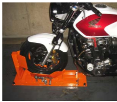
震度7の地震でもバイクが転倒しないよう安全性が確認された専用機器を設置しています。
